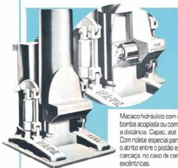
Macaco hidráulico com unha, bomba acoplada ou comando a distância. Capac. até 50 ton. Com rolete especial para evitar o atrito entre o pistão e a carcaça, no caso de cargas excêntricas.
