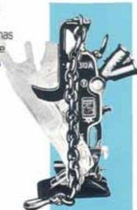
Macaco mecânico tipo cremalheira, com catraca e unha. Descida controlada, dente por dente. Capacidade 20 ton. Ref. - 2029
