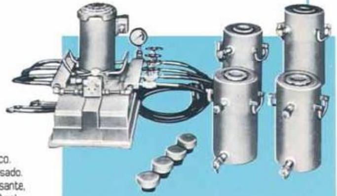
Conjunto de macacos hidráulicos. Ref: - RC-1110 - C com capacidade de 100 ton. cada, dupla ação, cilindro furo passante, acoplados a uma motobomba de acionamento elétrico. Ref: - E 605
