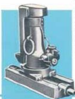
Tipo "JJ" montado sobre base, com movimento transversal. Acoplado com unha, para cargas onde o ponto de apoio para levanta-las, está muito próximo do chão. Capacidade de 10 a 50 ton.
