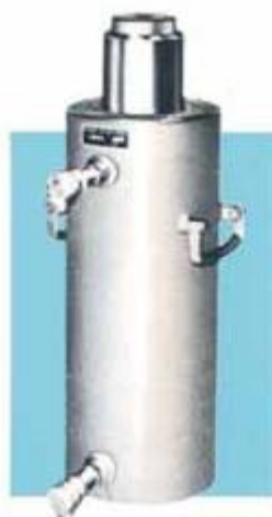
Macaco hidráulico, pistão com furo passante, dupla ação. Comando a distância, capacidade até 1000 ton. Acoplado a uma bomba de acionamento elétrico ou por motor a gasolina. De 1/2 a 7 1/2 HP.
